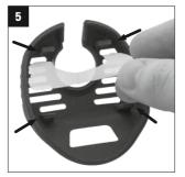
Entfernen Sie nun das Filtergitter – auch hier empfehlen wir die Verwendung eines Schraubendrehers. Legen Sie im Anschluss ein neues Filtergitter ein.
